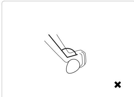
Los Ergogrips de woom están diseñados para apoyar la parte inferior de la palma de la mano del niño. Cuando tu hijo sujeta los puños en una posición normal de conducción, las muñecas deben estar ligeramente dobladas. Para ajustarlos, afloja el tornillo de la abrazadera del Ergogrip. Gira los puños hasta la posición deseada y aprieta el tornillo de la abrazadera al par de apriete recomendado.
