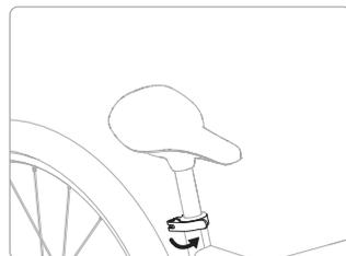
Schnellspannhebel vollständig schließen.
